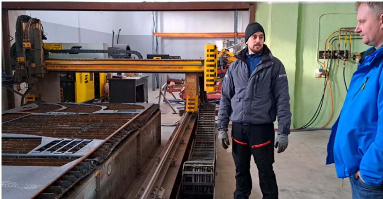
Metalli CNC-plasmasõidukis pink lõikab terast mööblit kergusega ning tagab alati täpsed detailid omatoodete valmistamiseks ja edasi töötlemiseks. Fotod: Kuido Merits
